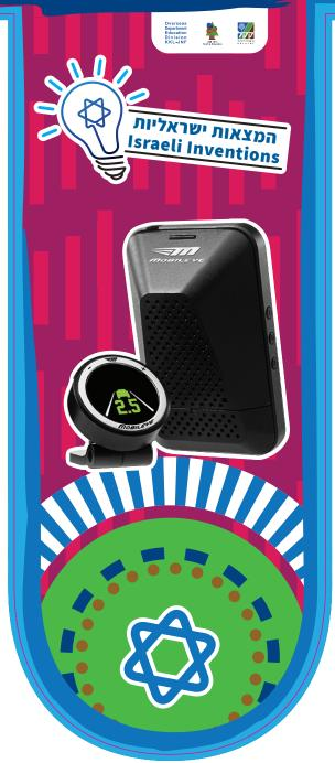
מערכת מובילאיי, שיש בה מצלמה אחת בלבד, מתריעה בזמן אמת מפני מגוון סכנות, כגון סכנת התנגשות וסטיית הרכב מנתיב הנסיעה. המערכת אף מזהה הולכי רגל, רוכבי אופניים ואופנועים בסביבת הרכב וכן תמרורי מהירות. למעשה, המצלמה משמשת כמעין "עין שלישית" עבור הנהג, והפונקציות של המערכת מסייעות במניעת תאונות דרכים ומהוות תשתית לפיתוח רכב אוטונומי. מובילאיי הוקמה בישראל, בשנת 1999, על ידי פרופסור אמנון שעשוע וזיו אבירם. חברה זו היא חלוצה ומובילה בתחומה.
